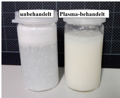
Abbildung 2: Darstellung der verbesserten Dispergierbarkeit eines Polymer (PEEK) –Pulvers in Folge einer Plasmabehandlung in Wasser
