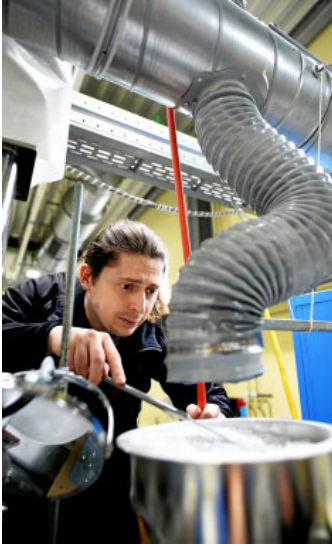
Christoph Kindler bestückt eine Anlage zur Herstellung von Smartmelamine, einem hitzebeständigen Vlies Foto: Tino Zippel
