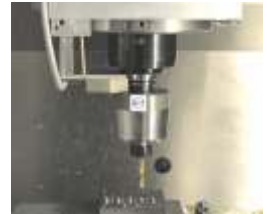
Mechatronisches Werkzeug mit integrierter Minimalmengenschmierung
